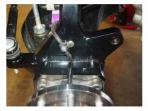
17. DRIVERS SIDE BRAKELINE – GET YOUR DRIVERS SIDE BRAKELINE BRACKET READY. REMOVE THE CLIP THAT HOLDS THE BRAKELINE TO THE BRACKET ON THE FRAME. SEPARATE THE HARD LINE FROM THE SOFT LINE AND FREE THE BRAKELINE FROM THE STOCK BRACKET. SLIDE THE NEW BRAKE LINE BRACKET OVER THE SOFT LINE AND REATTACH THE SOFT LINE TO THE HARD LINE. MAKE SURE YOU PUT THE BRACKET ON THE CORRECT WAY, USE THE PHOTO FOR REFERENCE. (2)==0 12MM FLARE NUT WRENCH)
